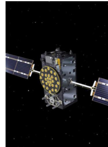
Satellite européen Galileo comportant 4 horloges atomiques à bord. © European Space Agency.
