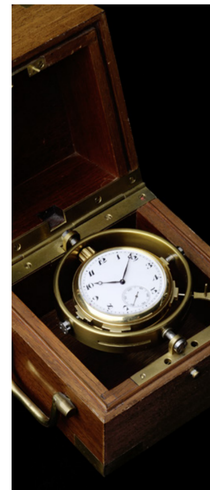
Montre de bord en or à tourbillon, fixée dans un coffret de chronomètre de marine avec suspension à cardan. Construit par James C. Pellaton pour Robert Cart, vers 1940. Le Locle, Suisse. MHL. Inv. 1056
